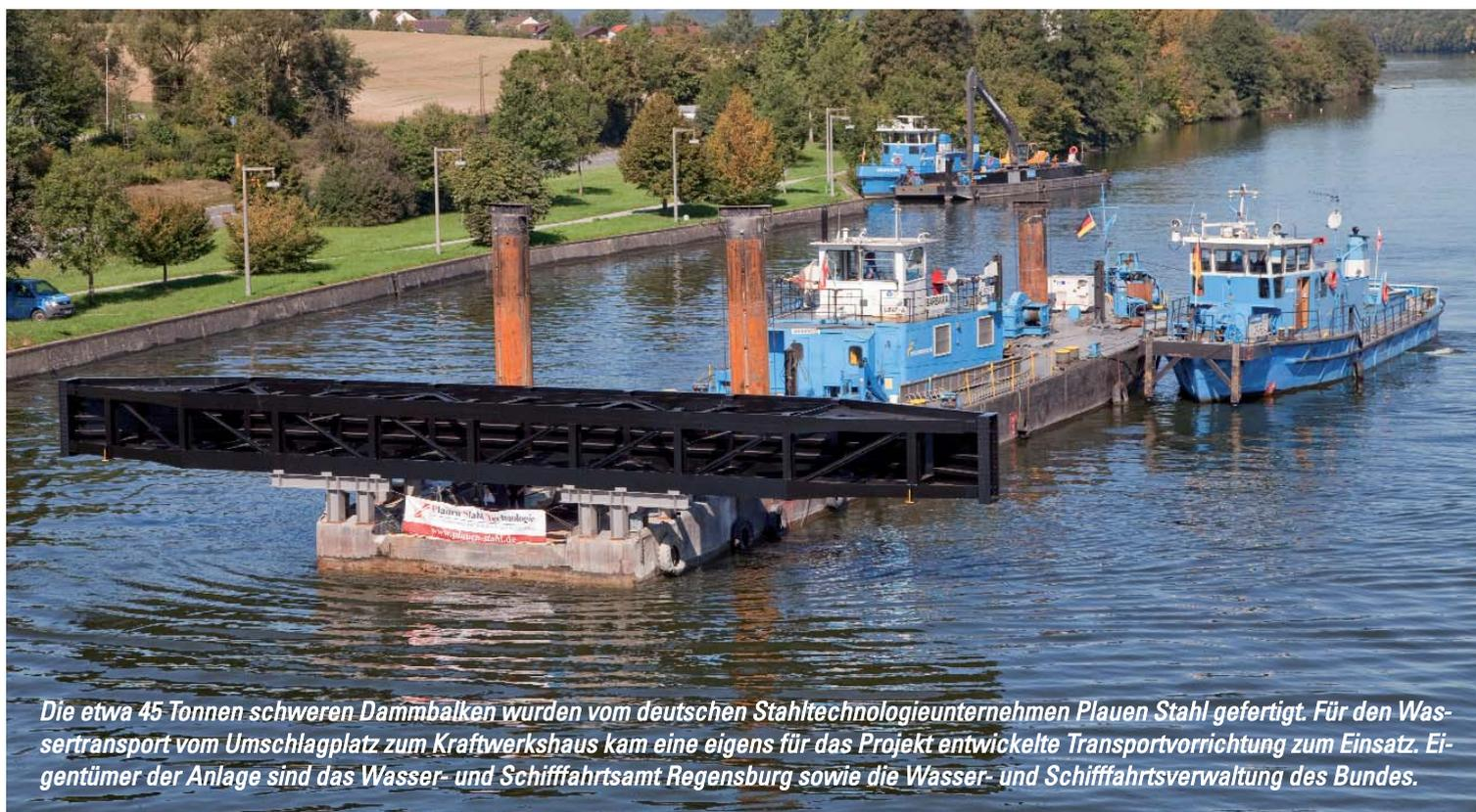
Die etwa 45 Tonnen schweren Dammbalken wurden vom deutschen Stahltechnologieunternehmen Plauen Stahl gefertigt. Für den Wassertransport vom Umschlagplatz zum Kraftwerkshaus kam eine eigens für das Projekt entwickelte Transportvorrichtung zum Einsatz. Eigentümer der Anlage sind das Wasser- und Schiffsamt Regensburg sowie die Wasser- und Schiffsverkehrsverwaltung des Bundes.
